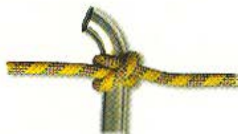
Ballestrinque sobre poste
